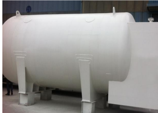
LNG storage tank & TCS
