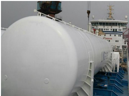
LNG storage tank & TCS
